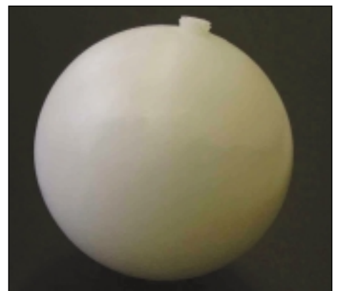
16 Makroverkapselung in Kunststoffkugeln (Quelle: Christopia, Frankreich).
